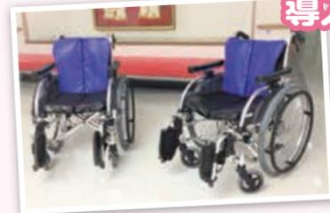
立ち上がると自動でブレーキがかかり、ブレーキのかけ忘れによる転倒を防止します。車椅子を自操するけれどブレーキのかけ忘れがある、そんなご利用者に使用いただきます。
